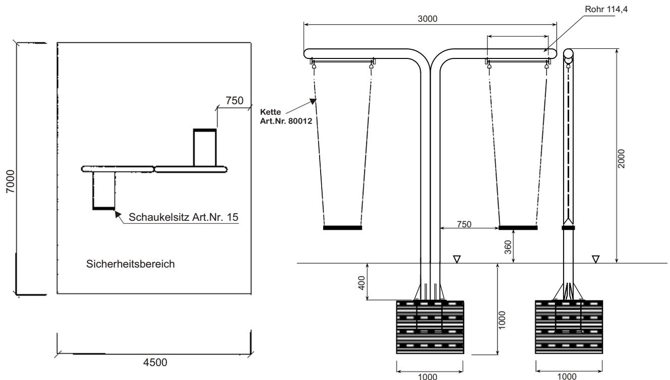
Einbauankerplatte 40 cm tiefer als Oberkante Gelände in Fundament **C30/37 (B35 KEIN STAMPFBETON!!!)** waagrecht einbauen. Nach Erhärten des Fundamentes (**min. 4 Wochen**), Schaukel auf Einbauankerplatte mit Muttern fest verschrauben und mit Sicherungsmuttern kontern. Dann kann der Fallschutzbereich wieder hergestellt werden.
