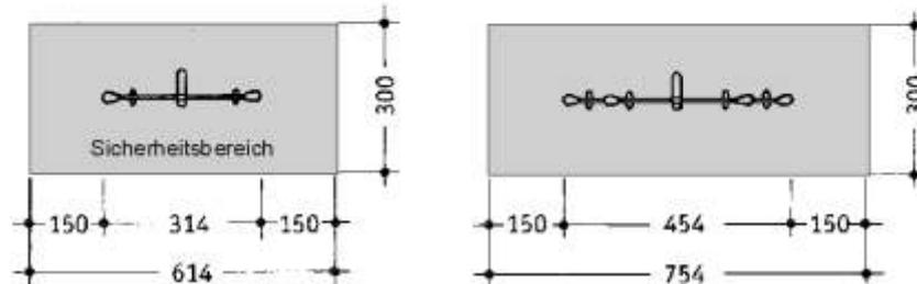
Fundament **C30/37 (B35 - KEIN STAMPFBETON!!!)** gemäß Zeichnung hergestellt. In dieses muss der beiliegende Fundamentkorb eingebracht werden (Fertigfundament separat erhältlich). Autoreifen ausrichten und mit dem Untergrund fixieren.
